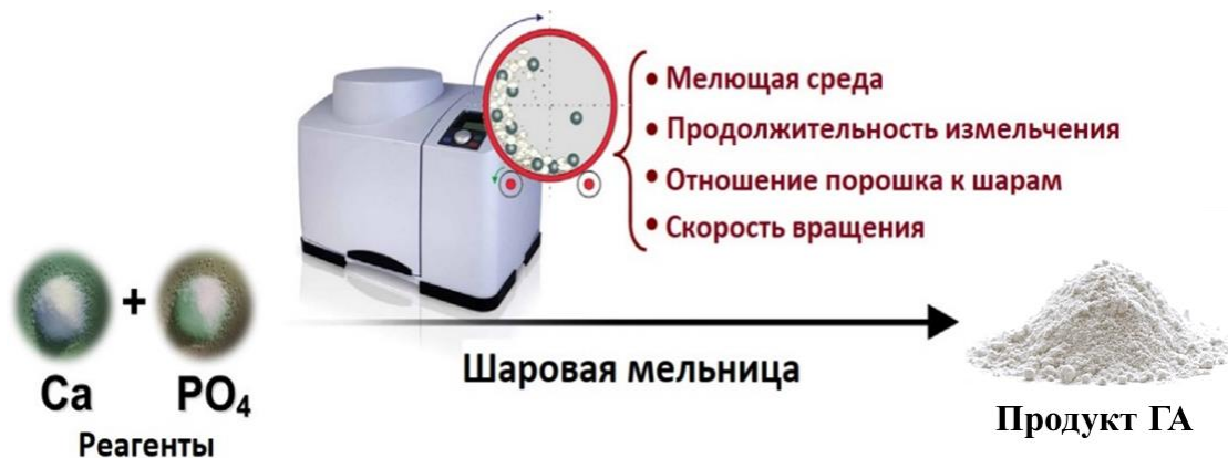
Рисунок 1.20 – Схема получения ГА механохимическим методом [18].
