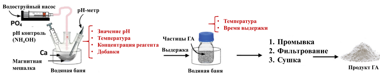
Рисунок 1.15 – Схема получения ГА методом осаждения [18].
