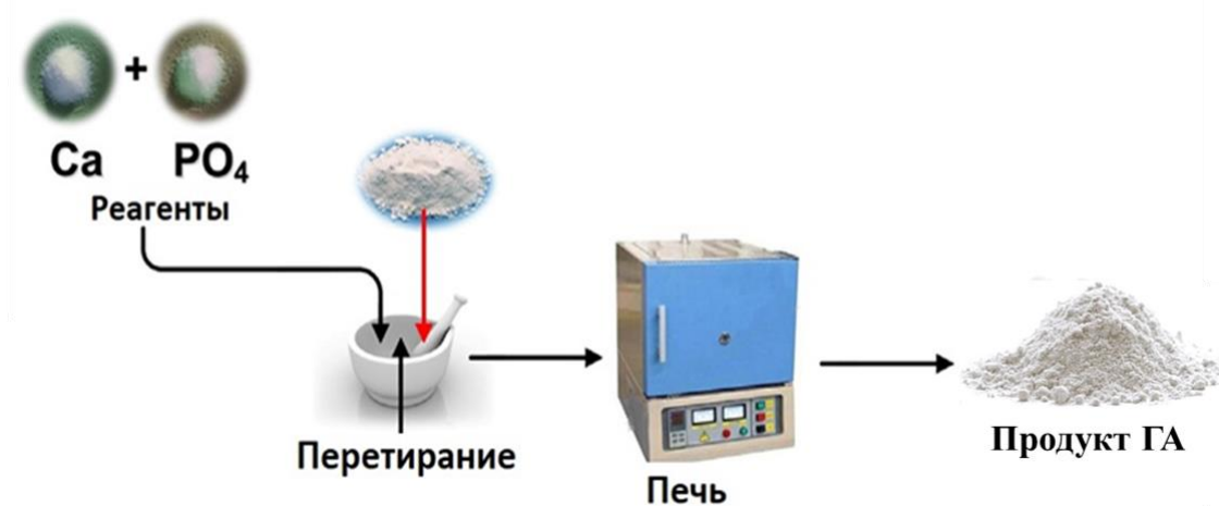
Рисунок 1.19 – Схема получения ГА керамическим методом [18].
