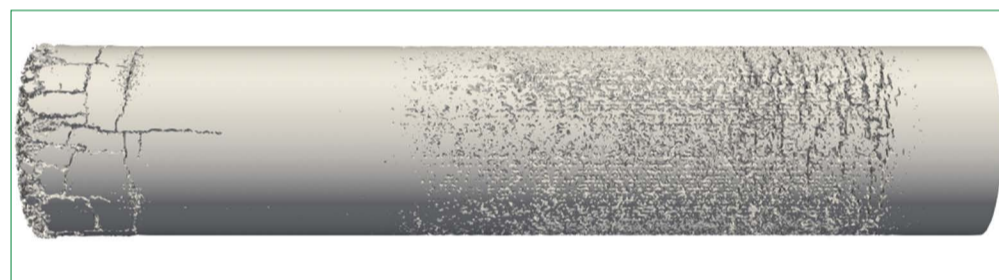
Развитие разрушений в цилиндре из силикатного стекла при динамическом воздействии
