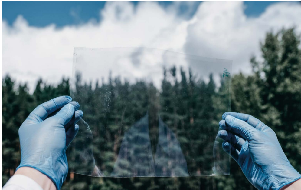
Микросетчатое прозрачное проводящее покрытие, созданное на основе активного самоорганизованного шаблона
